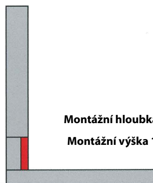
Instalace topného pásu ITS do zdiva
